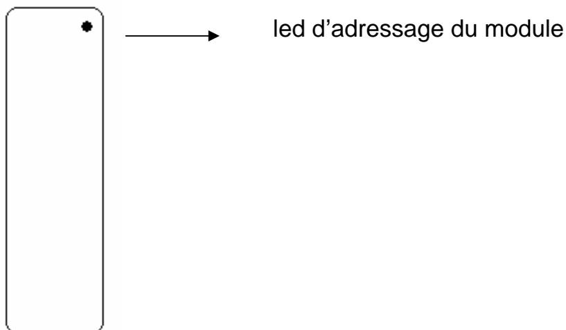
En face avant du boîtier, vous pouvez visualiser les accès effectués sur le module d'I/O.
